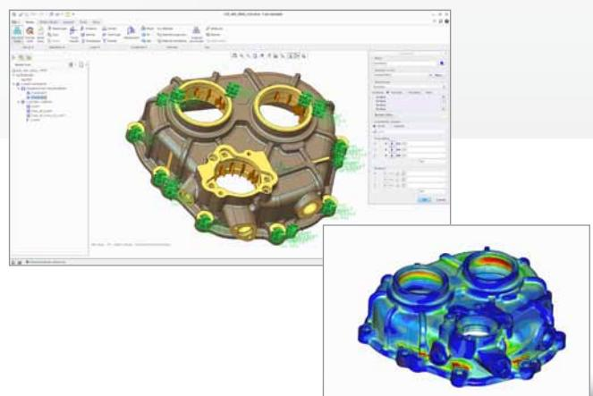
Creo Simulate を使用すると、モデルを解析して問題領域をすばやく特定できます。設計を更新するたびに解析モデルを作り直さなくても簡単に解析が行えます。
