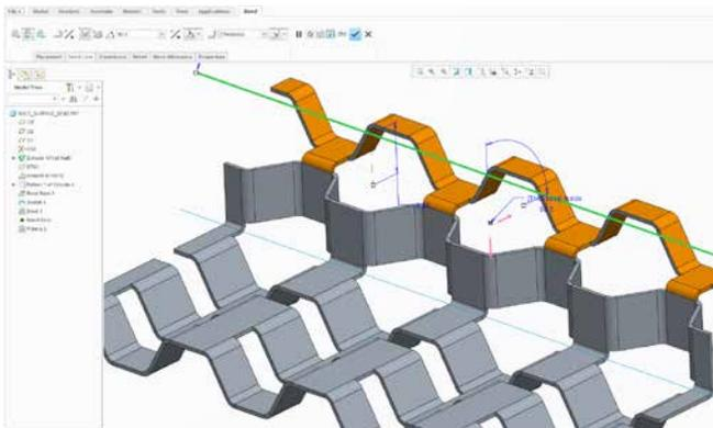
バンド リリースの適用、シートメタルのリップの作成、同一平面ジオメトリのバンドなどを自動的に実行する機能を使用して、板金ジオメトリを作成できます。
