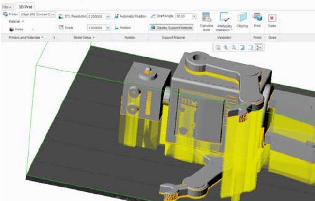
Creo では、プリントトレイにモデルを配置し、必要なサポート材料を表示することができます。
