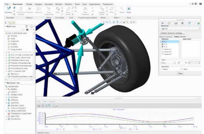
Mechanism Design により機械的結合を作成し、キネマティックアセンブリの動作をシミュレートできます。
